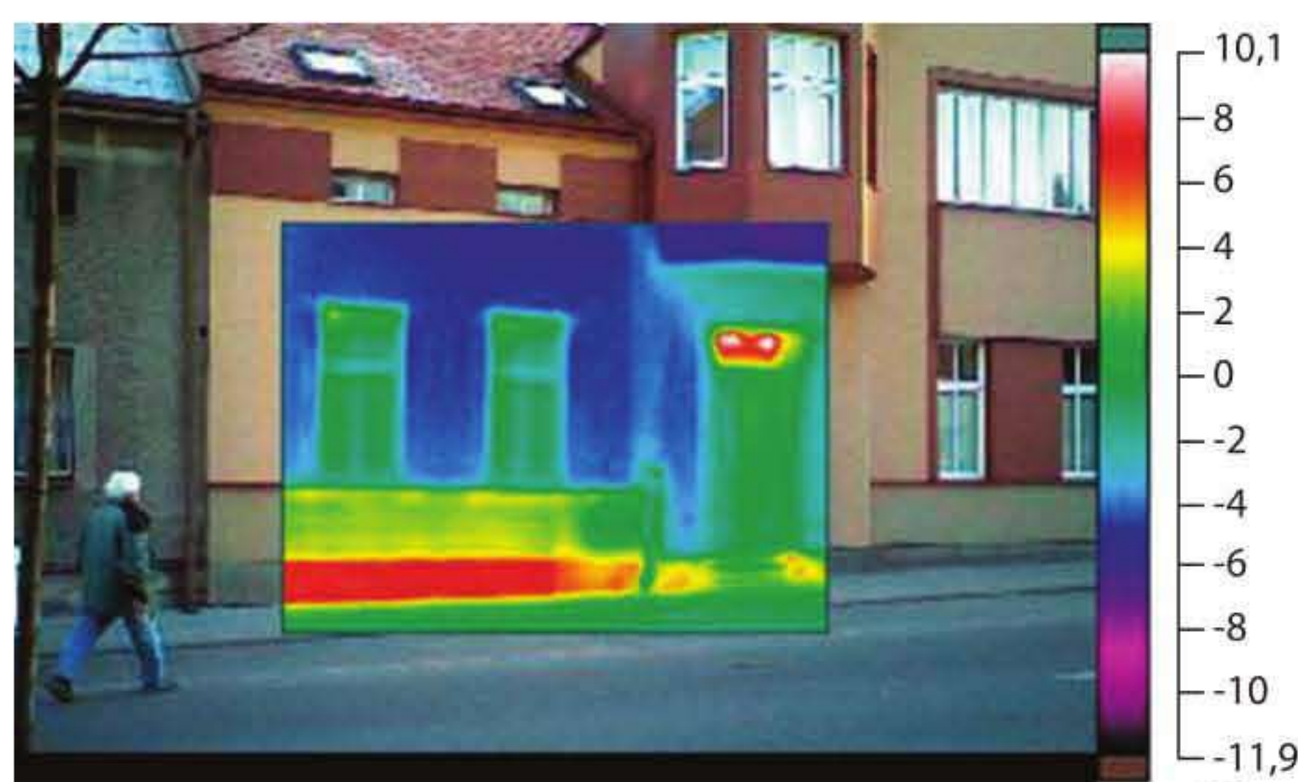
تصویر 34 - الف فرار حرارت از طریق تهداب ها
