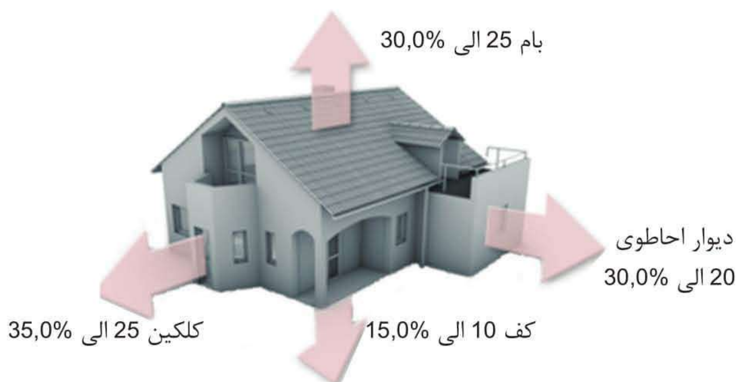
تصویر 40 - الف. معلومات تقریبی درباره فرار حرارت از طریق ساختار احاطوی بیرونی یک منزل رهایشی معمول
